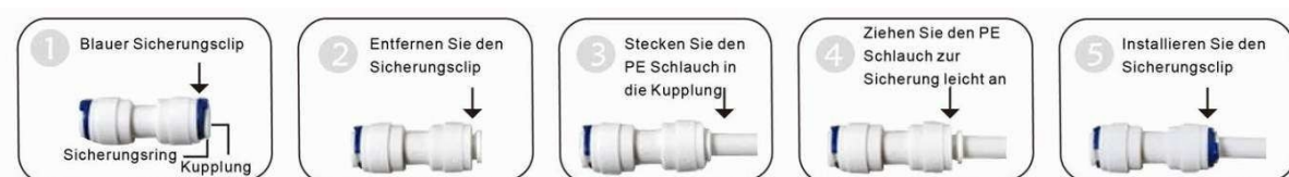
Tilslutning af slanger via lynkobling (indsæt slange)
